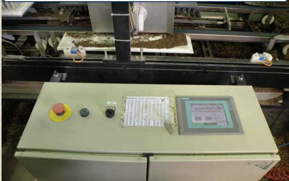
Αυτόματος έλεγχος μηχανής σποράς
